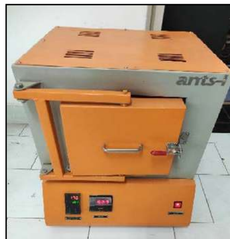
Machine: Muffle Furnace Model: 1400 Deg. Celsius Make: AntsProslys
